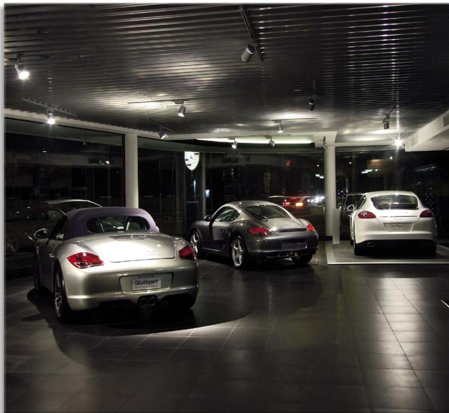
À esquerda, salão principal destacado por spots com foco orientável e fachos de 10° e 36°, fixados em trilhos eletrificados, com lâmpadas de descarga com bulbo cerâmico de 70W a 3000K. Abaixo, LEDs de 1W, com 10° de abertura, instalados no teto sobre a bancada do bar para iluminação pontual.
